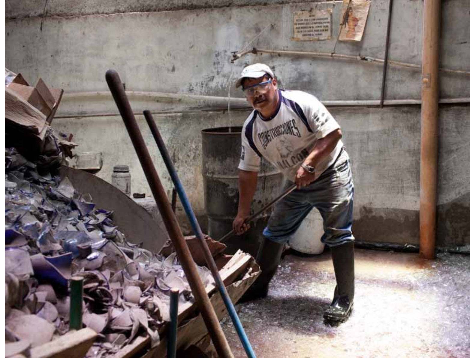
Recyclage. Rafael lave les tessons de verre avant de les charger dans le four.
